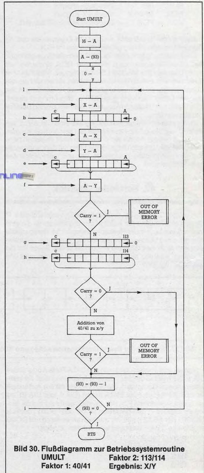
Bild 30. Flußdiagramm zur Betriebssystemroutine UMULT
